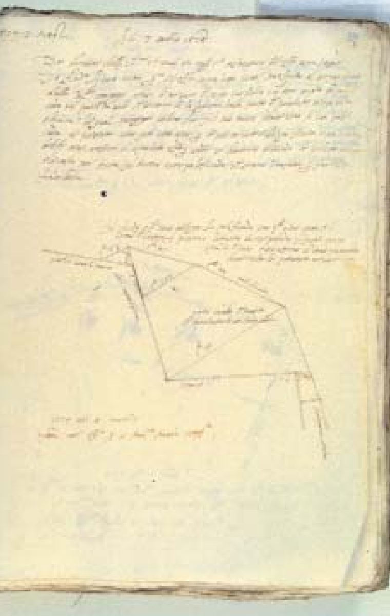
Andrea Fisaro, rappresentazione delle adiacenze del monastero del Corpus Domini a Santa Chiara con tracciati confinari e percorso di una costruenda palificata sulla laguna, 3 marzo 1574. ASVe, SEA, Relazioni, b. 530, dis. 1
